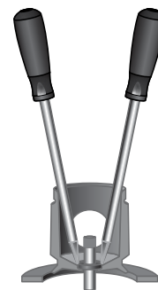
Figura 8: Remoción del sello mecánico
